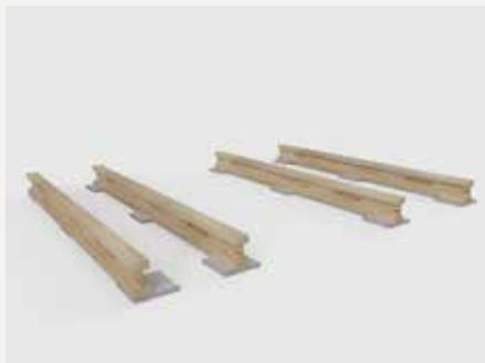
Le module est composé de **4 poutres de support** en bois Douglas classe 3, qui reposent sur des **dalles de support en béton, gravillonnées, de dimensions 40 x 40 cm**. Celles-ci sont positionnées à chaque point de charge et sont prévues afin de mettre le sol à niveau.
