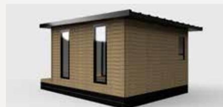
Ce bardage horizontal en pin, de classe 3, est ajouré et bénéficie d'un traitement autoclave teinté brun. Celui-ci apporte une finition design au module standard.
