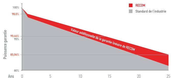
Production 1ere année  $\geq 98.0\%$  Baisse de puissance entre 2 et 25 ans  $\leq 0.54\%$  Puissance de sortie à 25 ans  $\geq 85.04\%$
